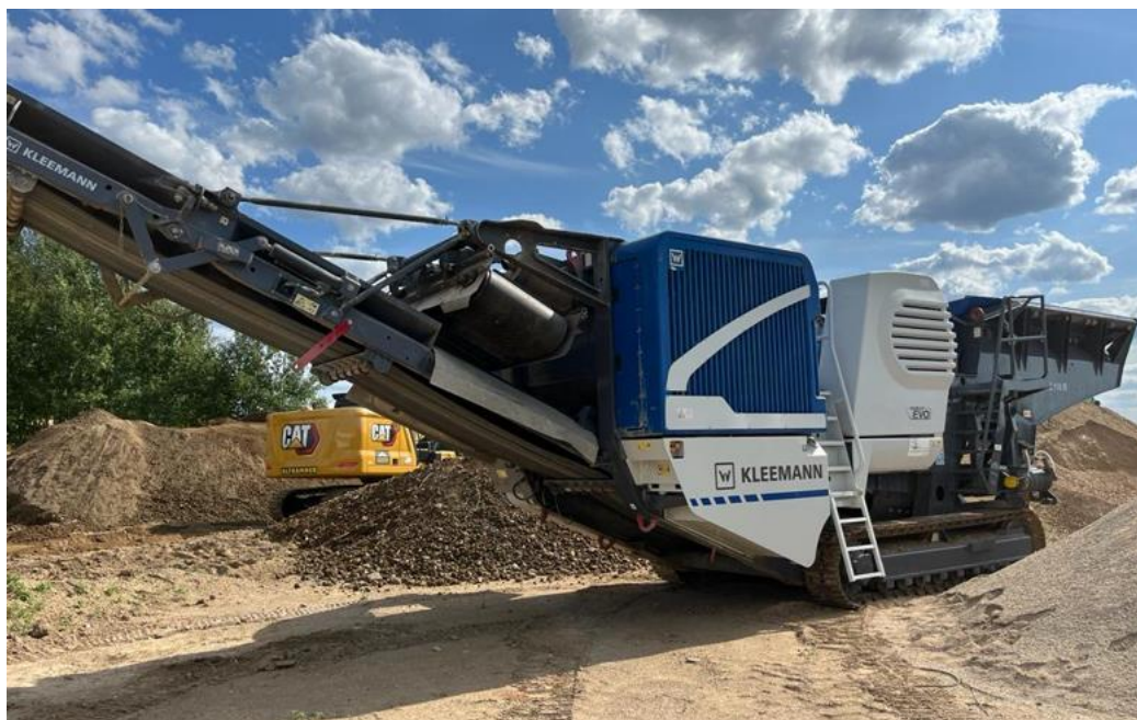
Rysunek 10. Przykładowa kruszarka z przesiewaczem
