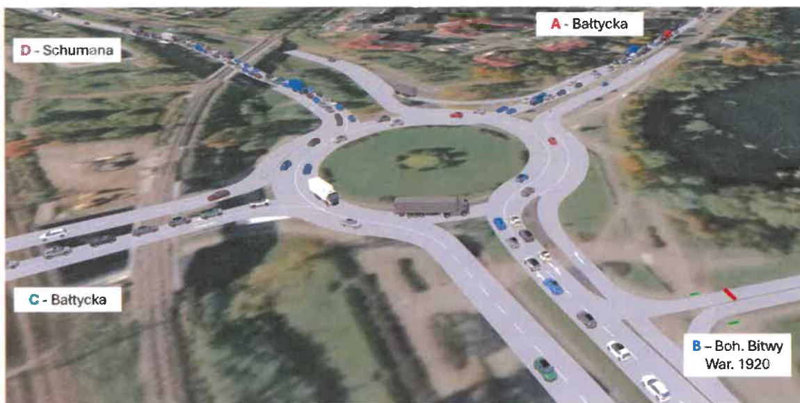
Rys. 4.6. Widok na przeciętny stan ruchu w szczycie porannym (przeciążenie wlotów A, C, D) – geometria ronda zgodna z założeniami rys. 4.5.
