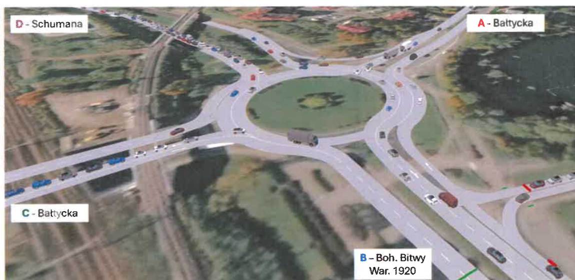
Rys. 4.7. Widok na przeciętny stan ruchu w szczycie popołudniowym (znaczne przeciążenie wlotu D ul. Schumana oraz pasa wewnętrznego wlotu C ul. Bałtyckiej) – geometria ronda zgodna z założeniami rys. 4.5.
