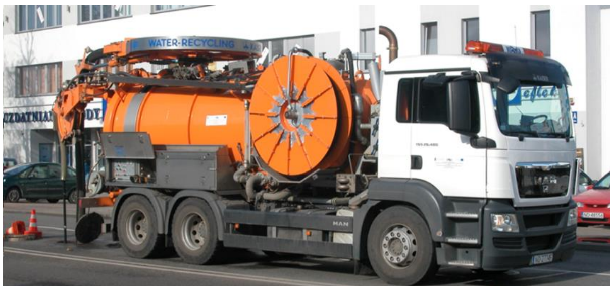
Fot. PWiK Sp. z o.o. Czyszczenie hydrodynamiczne sieci sanitarnej w ul. Lubelskiej
