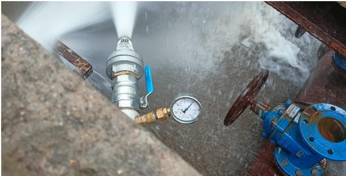
Fot. PWiK Sp. z o.o. Pomiar ciśnienia i wydajności przepływu w komorze przeciwpożarowej przy Pl. Jedności Słowiańskiej
