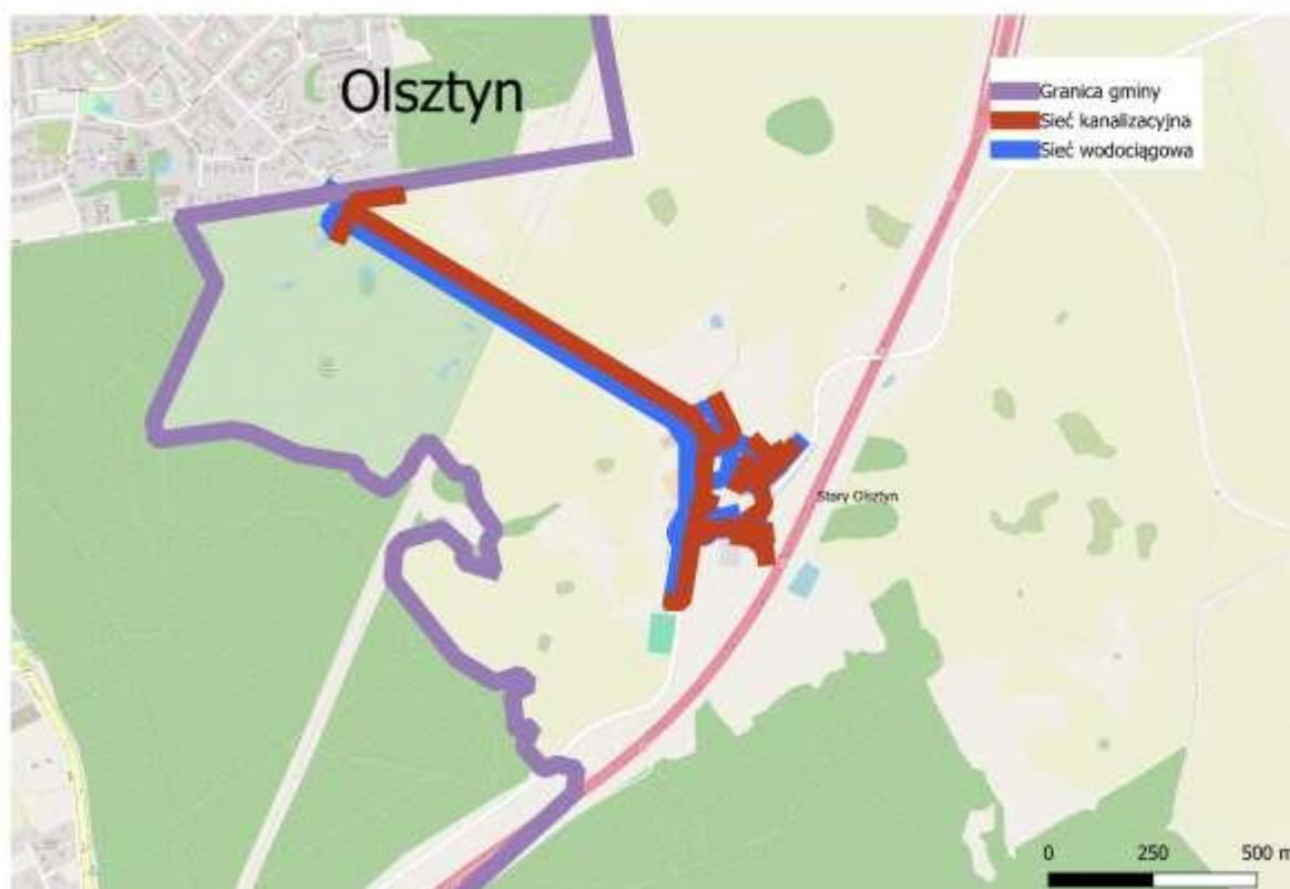
Rysunek 9. Sieć wodociągowa i kanalizacyjna na obszarze Starego Olsztyna - schemat poglądowy
